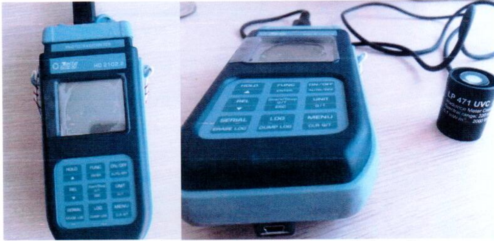
Şekil 3: Ölçümlerde kullanılan UVC metre - ışık ölçer cihaz
